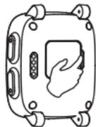
1. デバイスの電源をオフにして、プラスチックSIMカバーを開きます。
