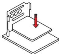
2. メタルSIMスロットカバーを押し開き、金属ピンを下に向けてSIMカードを取り付けます。
